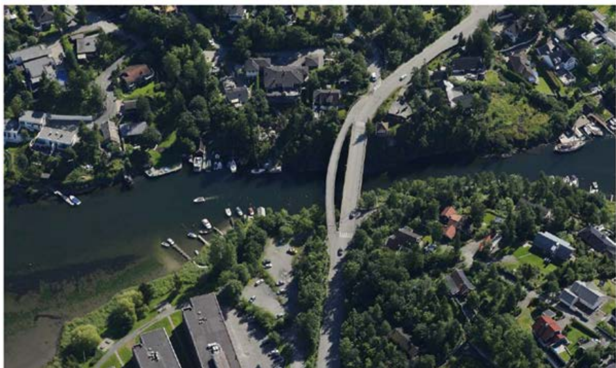
Figur 19: Fotomontasje av buet GS bru og eksisterende bru sett ovenfra. Illustrasjon: Norconsult.
